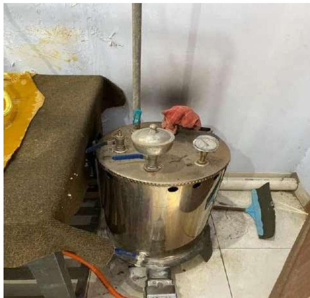
Gambar 4: Boiler setrika uap / tabung uap setrika
